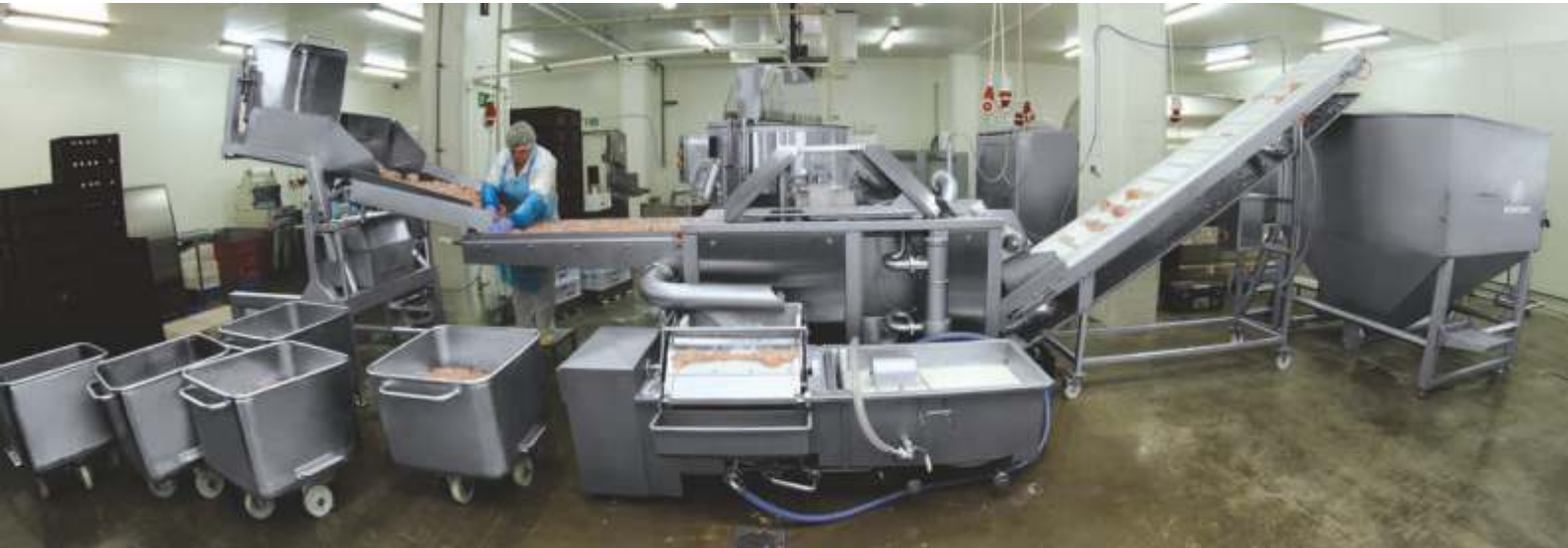
промышленная линия для инъекции филе птицы
