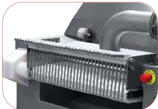
уникальная система устранения чрезмерного кол-ва рассола с поверхности инъектируемого сырья
